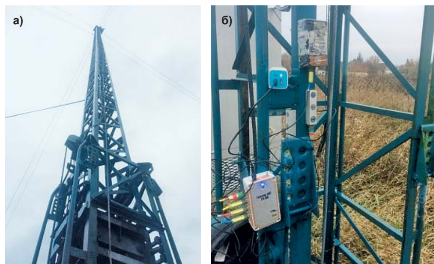
Рис. 6. Мачта анемометра, оборудованная вибродатчиками: а) общий вид опоры анемометра; б) установка измерительного комплекса на опору анемометра
